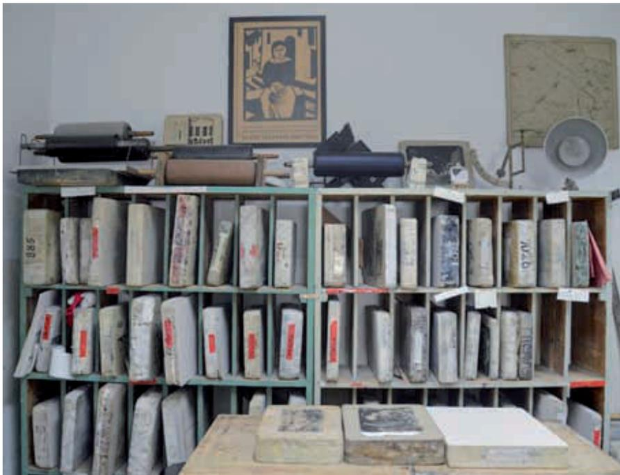
In der Werkstatt werden die verwendeten Drucksteine aufbewahrt – und unter Umständen später wieder eingesetzt.
